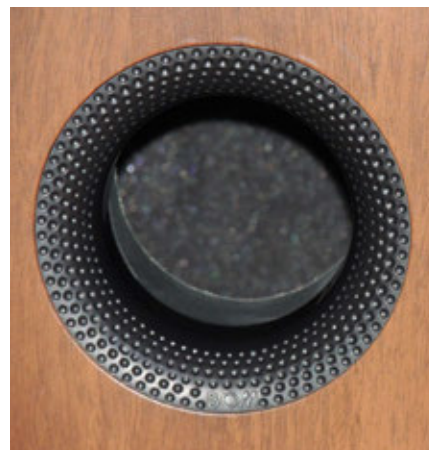
Il foro dell'accordo reflex lavorato per ridurre le turbolenze del flusso d'aria.
