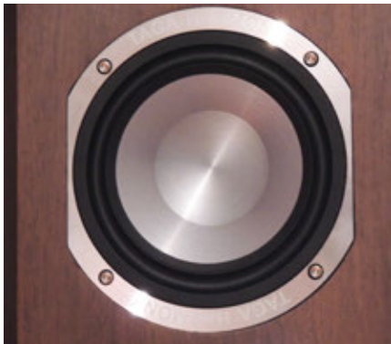
Il medio dalla membrana in alluminio.
